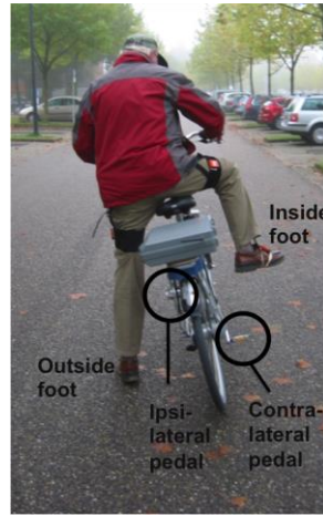
Figuur 1a. Bevestiging van de inertiaële sensoren aan de fiets en fietser. b. Beschrijven van op- en afstappen: buitenste voet, binnenste voet, ipsilaterale pedaal, contralaterale pedaal en zadel.
