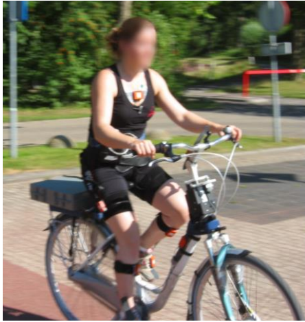
Figuur 1a. Bevestiging van de inertiaële sensoren aan de fiets en fietser. b. Beschrijven van op- en afstappen: buitenste voet, binnenste voet, ipsilaterale pedaal, contralaterale pedaal en zadel.
