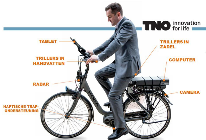
Figuur 3: De “intelligente fiets” met de achteruitkijk-assistent: camera achterop de fiets, trillers in het zadel, computer koffer nog achter op voor meetsystemen.
