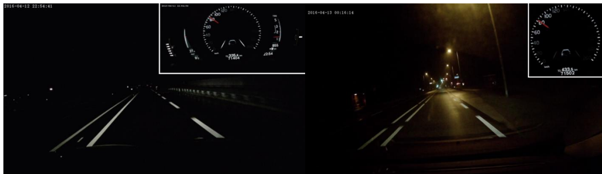
Figuur 8: Invloed wegverlichting op contrast markering
