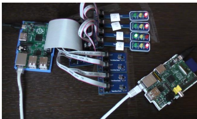
Figuur 3: testopstelling met 2 Raspberry Pi's (beide met Debian Linux)
